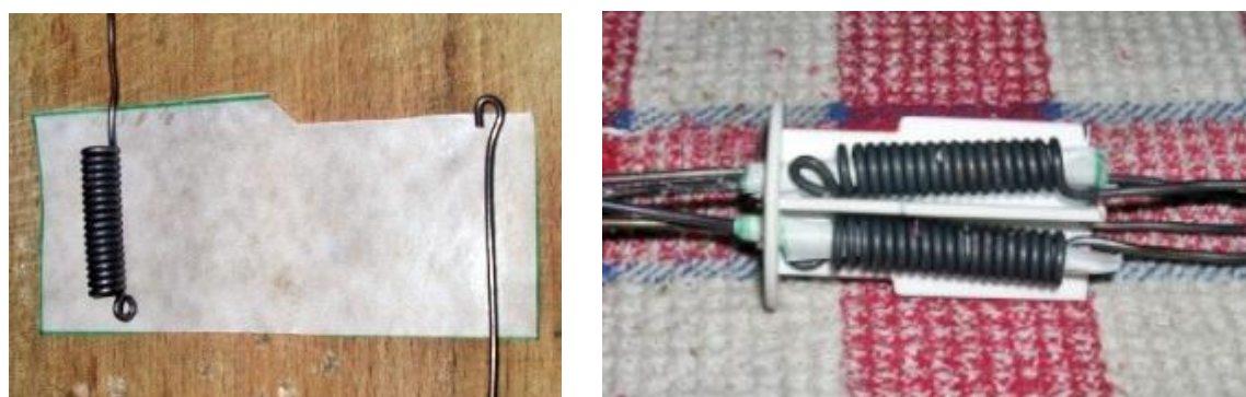
Rysunek 22. Docięcie papieru i segment ze strzykawki 100 ml (źródło: archive.org/details/MagravCapacitorsType2 )
