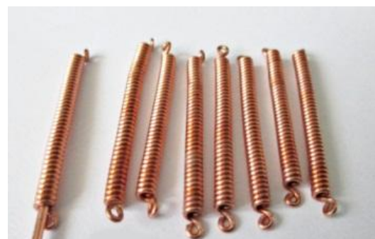
Rysunek 10. Sprężynki łącznikowe drut 1mm (ż. własne)
